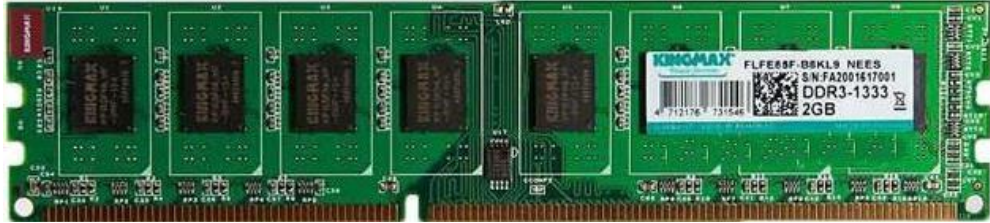
Şekil 7.11. DDR3 SDRAM modülünün yapısı
