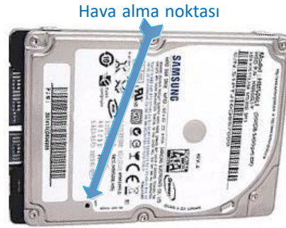
Şekil 8.3. Harddisk içerisinde iç basıncı dengeleyen hava alma noktası
