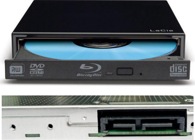
Şekil 8.20. Bir Combo DVDRW ve Blue-ray sürücünün ön ve arka görüntüsü
