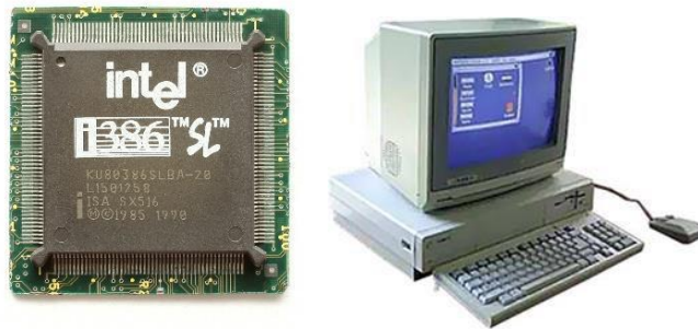
Şekil 2.15. 1985'li yıllarda üretilen Intel i386 merkezî işlem birimi ve bu birimine sahip bilgisayar
