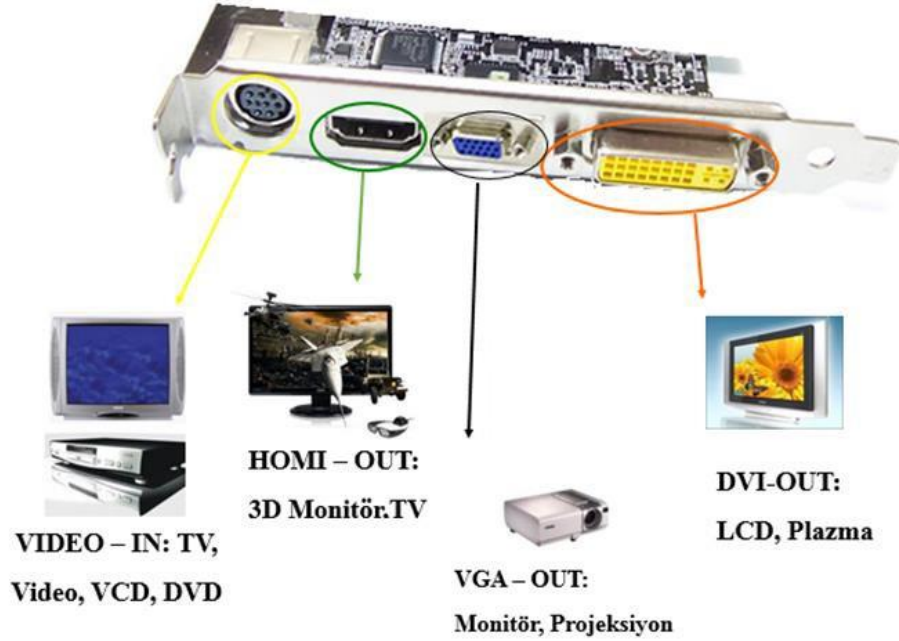
Şekil 9.4. Bir harici ekran kartında bulunan çıkış portları ve desteklediği cihazlar.
