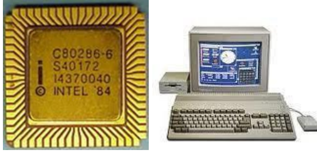
Şekil 2.14. Intel 80286 işlemci ve bu birimine sahip bilgisayarın görünümü
