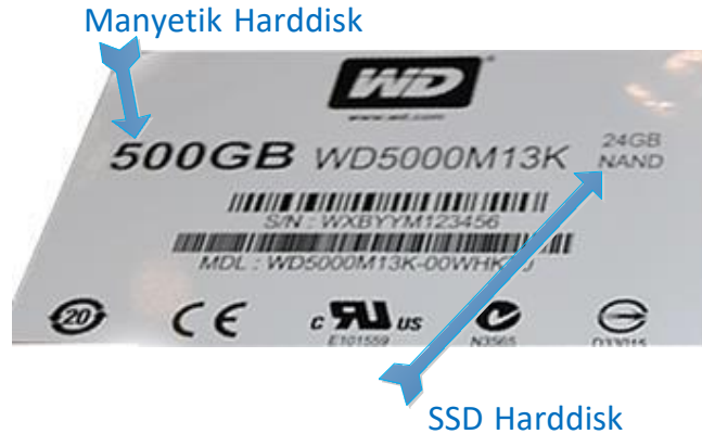
Şekil 8.18. Bir hibrit harddiskte bilgi etiketi
