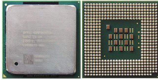
Şekil 6.12. Pentium 4 işlemcinin ön ve arka yüzleri
