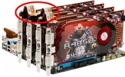
Şekil 9.13. Crossfire teknolojisiyle performansı artırılmış ekran kartlarının görüntüsü
