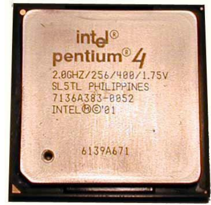
Şekil 6.18. İşlemciyle ilgili bazı bilgiler işlemci üzerinden okunabilir.
