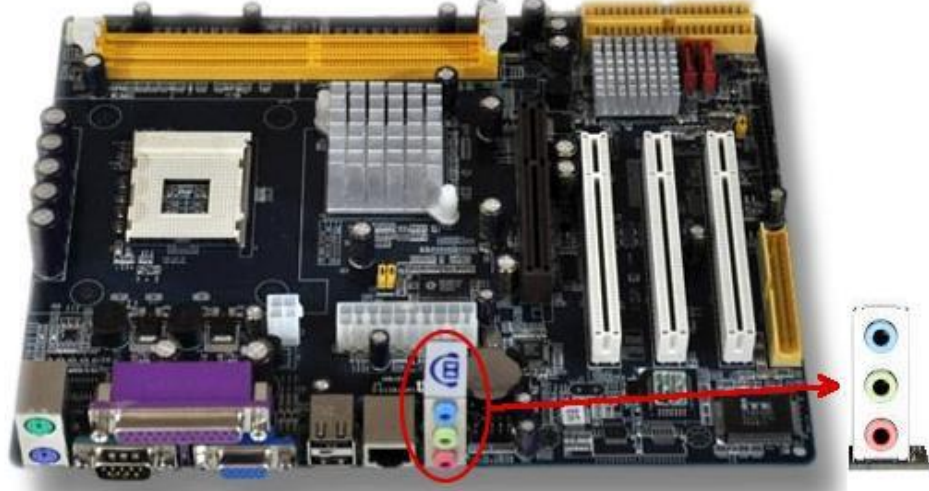
Şekil 11.2. Anakart üzerinde bütünleşik (onboard) ses yongası
