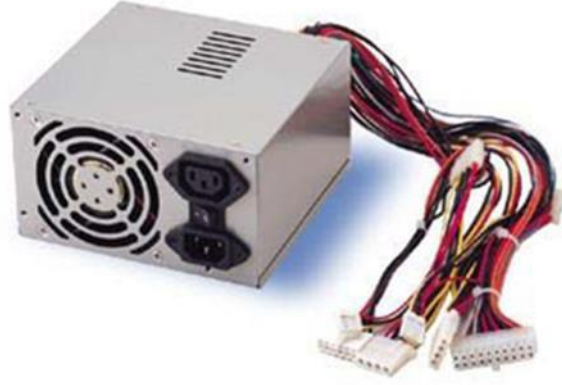
Şekil 3.4. Bilgisayar kasası içerisinde bulunan güç kaynağının görüntüsü
