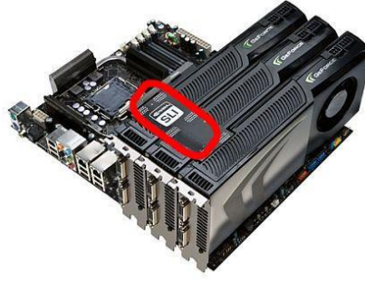
Şekil 9.12. SLI teknolojisiyle performansı artırılmış ekran kartlarının görüntüsü
