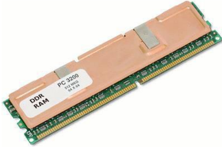
Şekil 3.3. Soğutucu takılmış 400Mhz hızındaki DDR RAM görüntüsü
