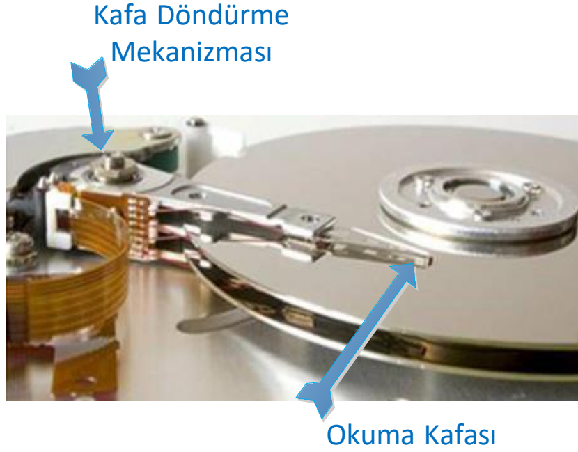
Şekil 8.5. Sabit disk içindeki bilgi okuma mekanizması
