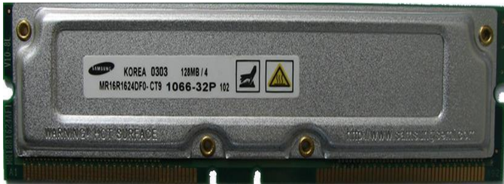
Şekil 7.8. RDRAM modülünün yapısı
