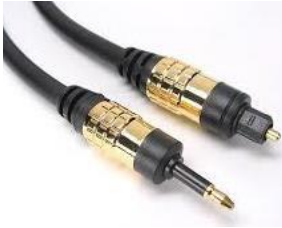
Şekil 12.6. Bilgisayar ile cihazları birbirine bağlayan fiber optik kablo şekli
