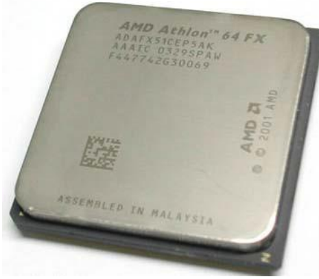
Şekil 6.18. İşlemciyle ilgili bazı bilgiler işlemci üzerinden okunabilir.
