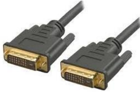
Şekil 12.11. Bilgisayar ile LCD monitörü birbirine DVI bağlantı kablosu ile de bağlanır.
