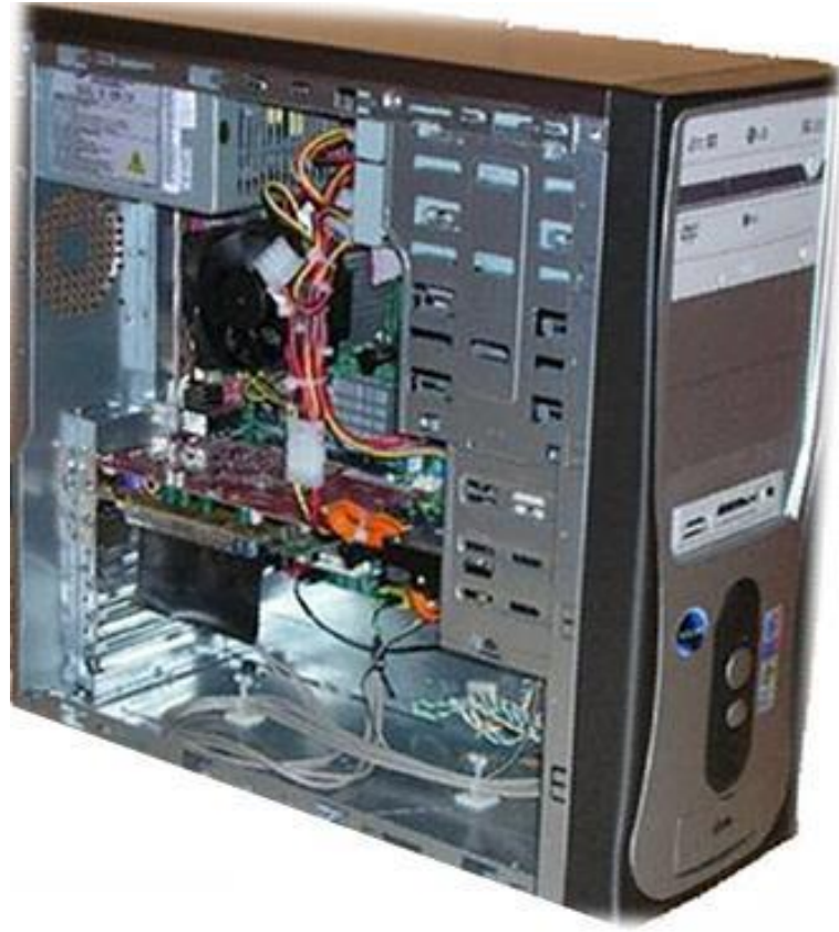
Şekil 3.5. Bilgisayar kasasının dış kapağı açılmış, iç görüntüsü
