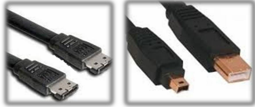
Şekil 12.7. Bilgisayar ile cihazları birbirine bağlayan ve e-Sata ve FireWire kablo şekli
