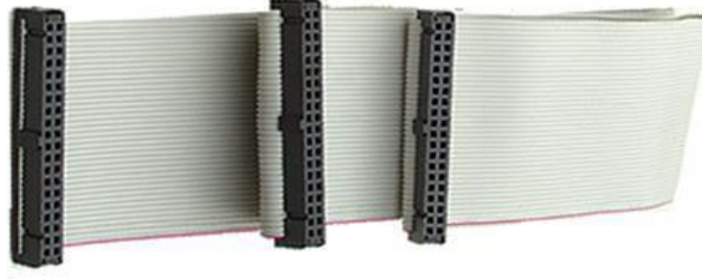
Şekil 8.8. Veri akışını sağlayan ATA 33, 40 Pin'lik IDE kablo
