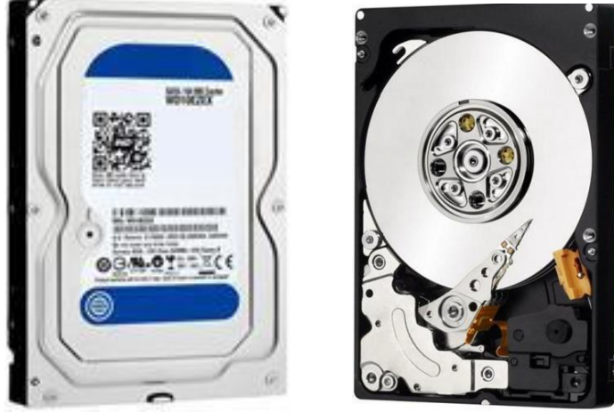
Şekil 8.1. Manyetik sabit diskin dış ve içi görünümü
