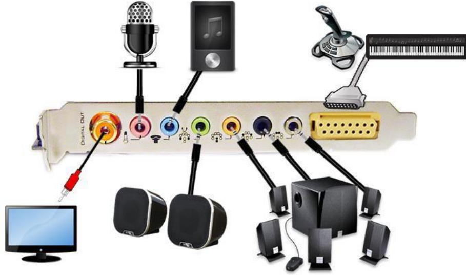
Şekil 11.9. Ses kartı Portları ve Portları kullanan cihazlar
