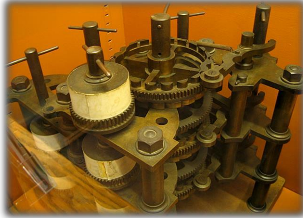
Şekil 2.5. Babbage Analitik Motor adı verilen bir mekanik hesaplayıcısı
