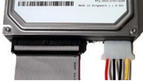
Şekil 8.10. Veri akışını sağlayan IDE kablo ve Güç kablosunun bağlantı şekli
